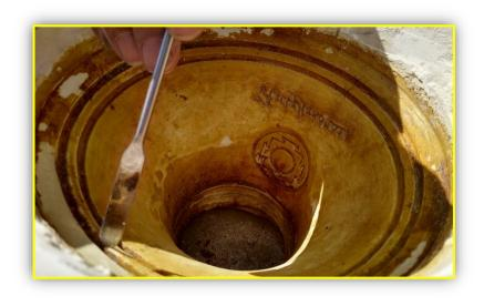
I prossimi passi saranno quelli di pulire il bronzo attraverso fusioni successive, finire di pulire il calco e infine colare il bronzo all'interno del calco per ottenere... la campana.
